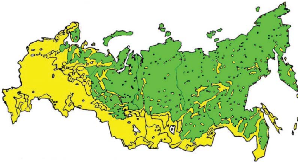
Рис. 1. Централизованное и автономное (соответственно желтый и зеленый секторы) энергоснабжение на территории России
