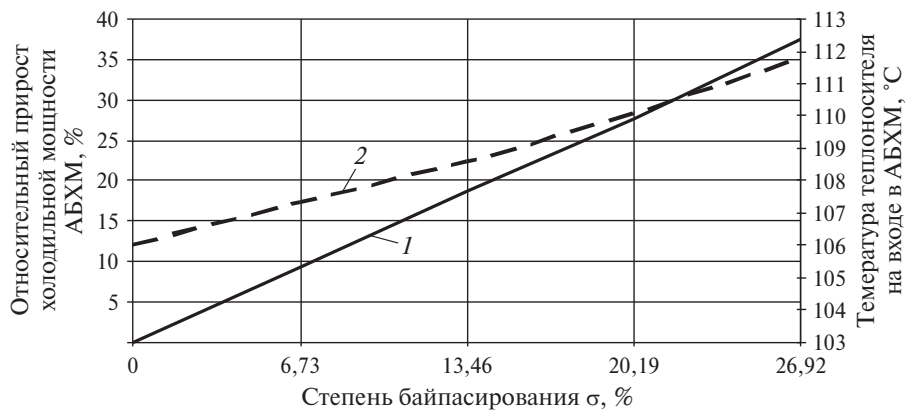
Рис. 3. Зависимости относительного прироста холодильной мощности (кривая 1) и температуры теплоносителя на входе в АБХМ (кривая 2) от степени байпасирования теплоносителя
