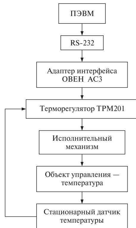
Рис. 1. Функциональная схема автоматизации управления электродным водонагревателем
