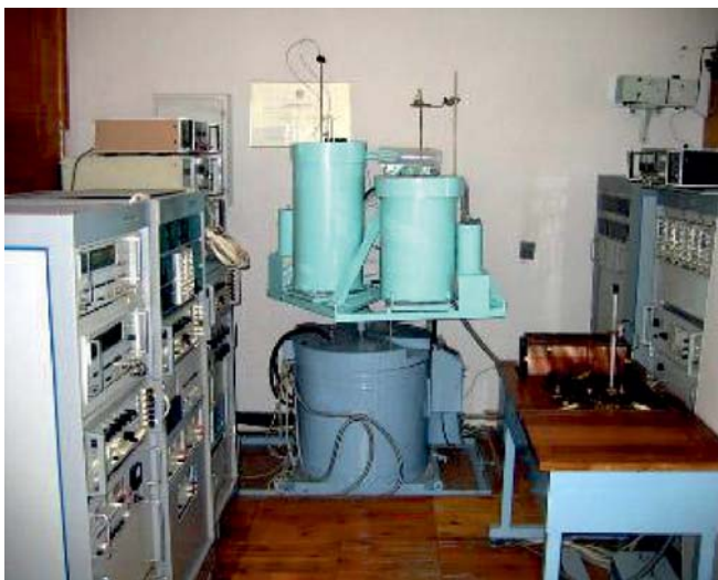
Рис. 1. Внешний вид государственного специального эталона единицы удельной теплоемкости твердых тел ГЭТ 67-75 в диапазоне температур 1337 – 1800 К
