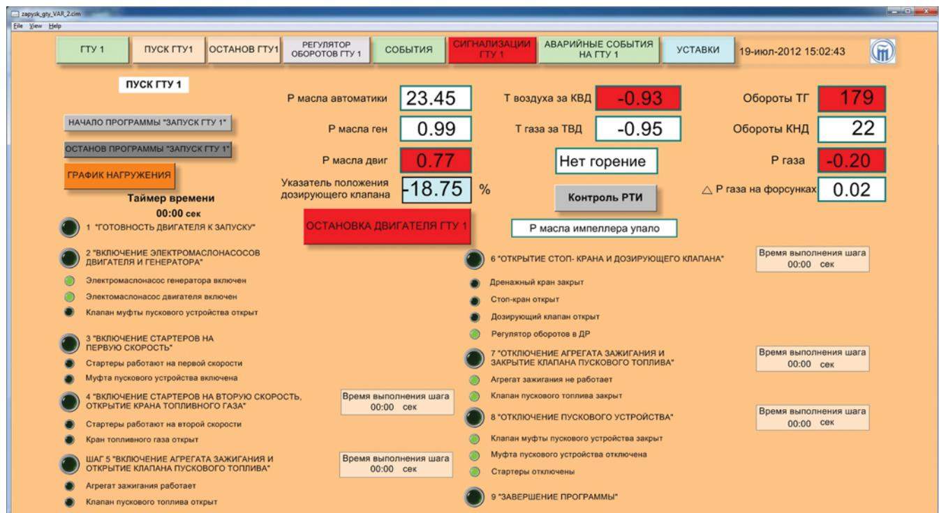
дача модернизации — разработка и реализация технологических защит и автомата пуска ГТУ. В объем модернизации входила замена всех основных исполнительных устройств систем топливоподачи и продувки ГТУ — дроссельного крана, стоп-крана, дренажного крана и т. д.
