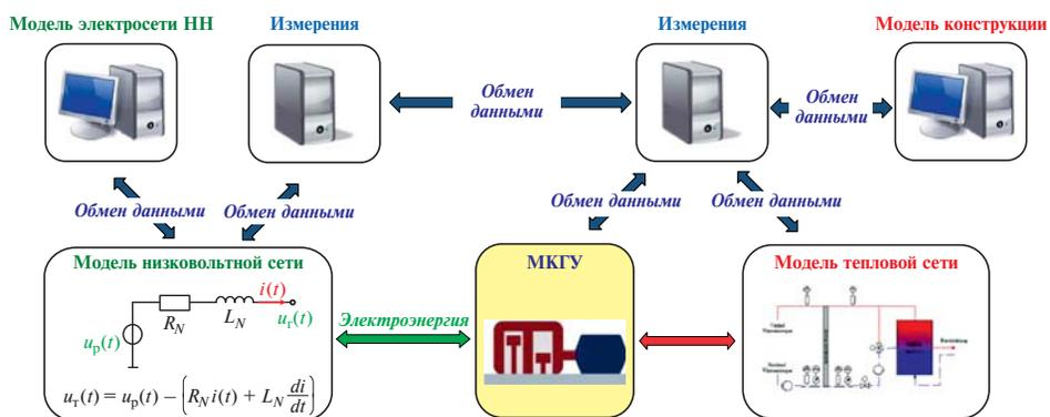
Рис. 4. Структура комбинированной энергетической установки
