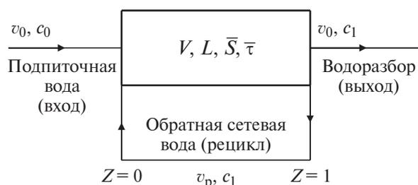
Рис. 3. Структура потоков для проточного реактора идеального вытеснения с рециклом (модель системы ТЭЦ — открытая теплосеть)
