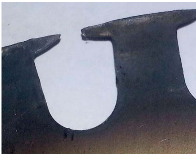
Рис. 2. Внешний вид зубцовой зоны после тепловых испытаний
